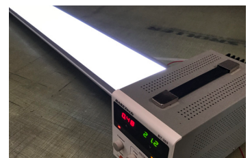
Kontrol af lysudbytte i et FrontSignLED® lysskilt.
