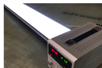
Kontrol af lysudbytte i et FrontSignLED® lysskilt.
